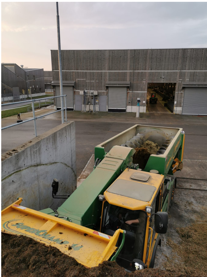
Der Mischwagen fährt täglich mehrere Betriebe an. Hier mischt er das Futter am Strickhof in Lindau. Bild: Strickhof
