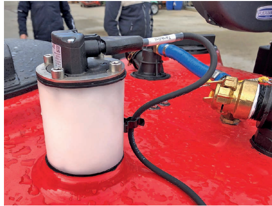
Digitaler Füllstandsensord auf der Fassoberseite (Schallmessung).
