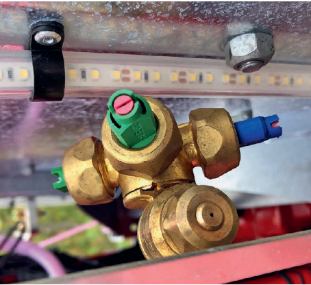
Dreifachdüsenträger mit Lechler AD grün 300–400 l; Albusz CVI grün Injektordüse für 300–400 l und Albusz CVI blau Injektordüse für 800–1000 l.
