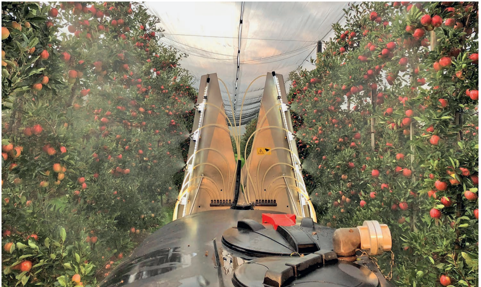
AD-Düsen im Einsatz bei den Abschlussbehandlungen (300–400 l/ha). Der Sprühnebel ist kaum sichtbar.
