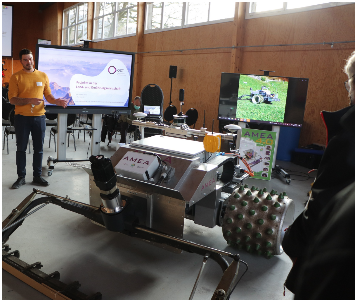
Bild 2: Futuristischer Grasschnitt für die Berge: Autonomer Mäher mit elektrischem Antrieb.
